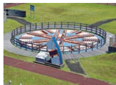
▲敷地内にトンネルを掘るときに使用したシールドマシンのカッターヘッド部分が展示されている
